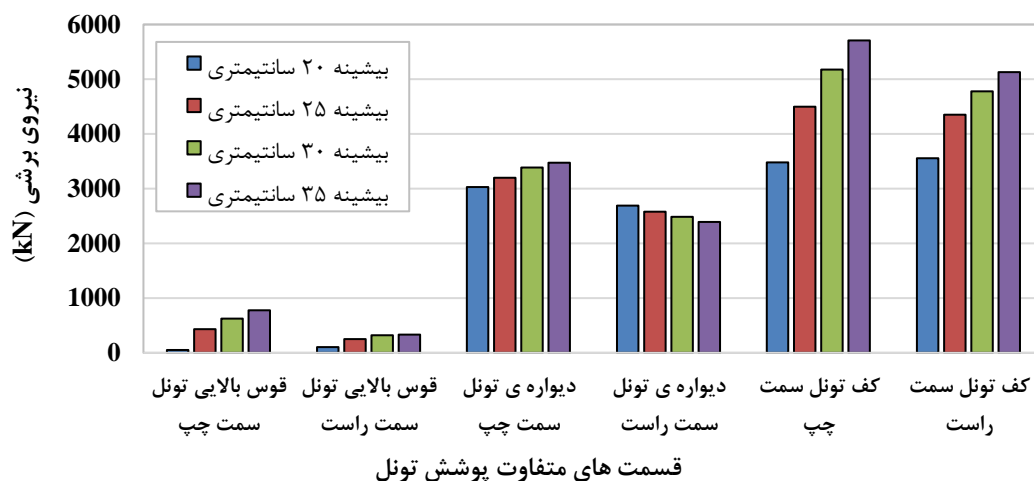
شکل ۱۴. بیشینه مقادیر نیروی برشی در قسمت‌های متفاوت تونل با ضخامت متفاوت پوشش
