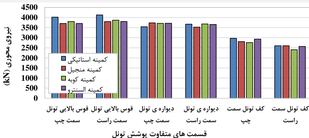
شکل ۲۳. کمینه مقادیر نیروی محوری در قسمت‌های متفاوت تونل در شرایط لرزه‌ای گوناگون
